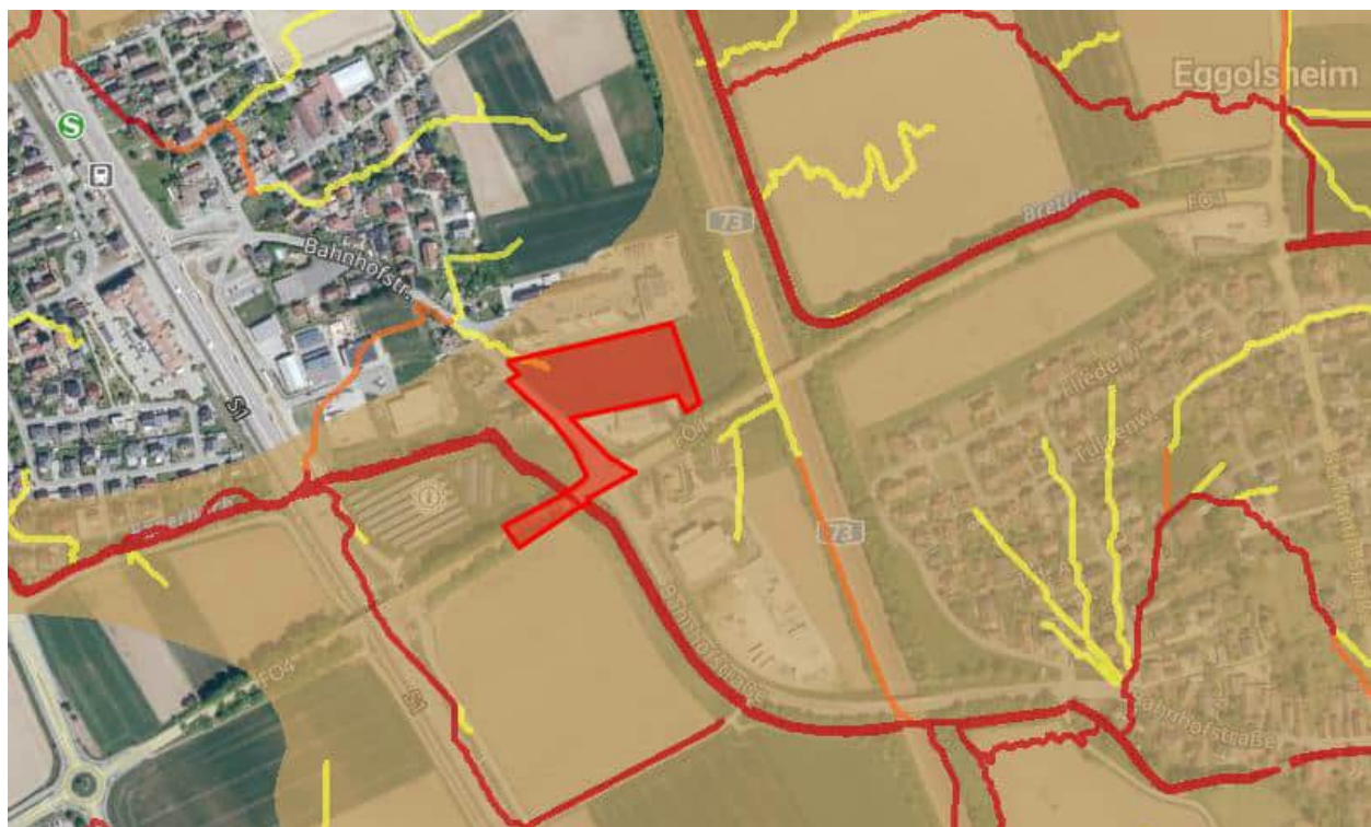
Abbildung 8: Wassersensibler Bereich (braun hinterlegt), Potentielle Fließwege bei Starkregen (rot-orange-gelb), Geltungsbereich (rot umrandet) (BayernAtlas 2026)
